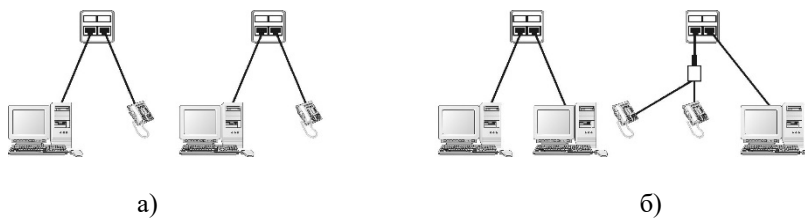
Рис. 60. Пример подключения к СКС категории 5е или 6 с двух-портовыми ИР дополнительного высокоскоростного устройства без изменения исходного уровня информационной поддержки:
